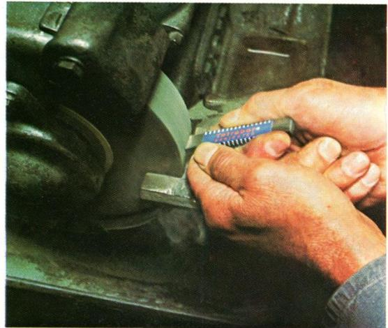
Tetrabor®-Abrichter eignen sich ebenfalls durch Form und Größe für das Abrichten einfacher Schleifscheibenprofile.
